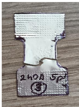
30. ábra A lépcsős tönkremenetel látható az elszakított próbatesteken is (saját felvétel)
