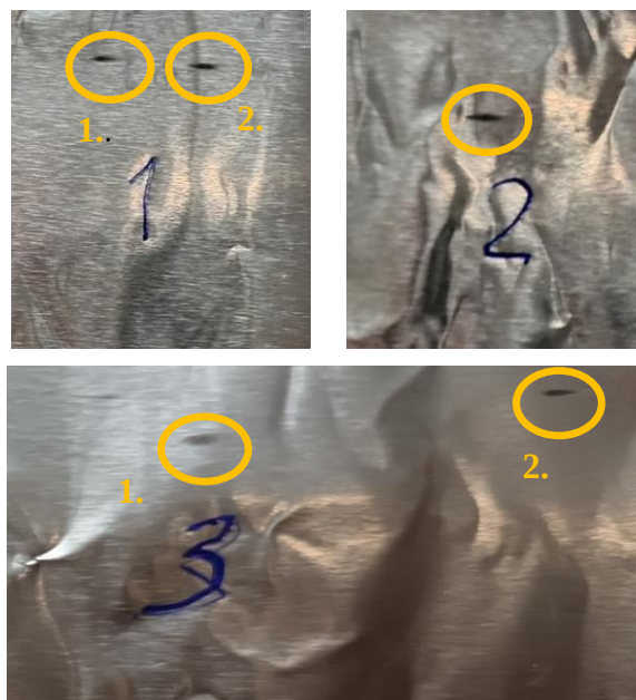
12. ábra A felületen lévő lerakódások jelölése
