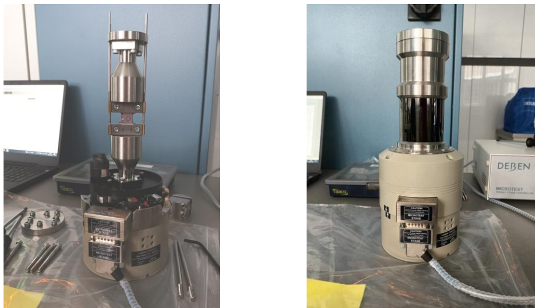
21. ábra Deben CT5000RT in-situ vizsgálatra alkalmas anyagvizsgáló berendezés (saját felvétel)
