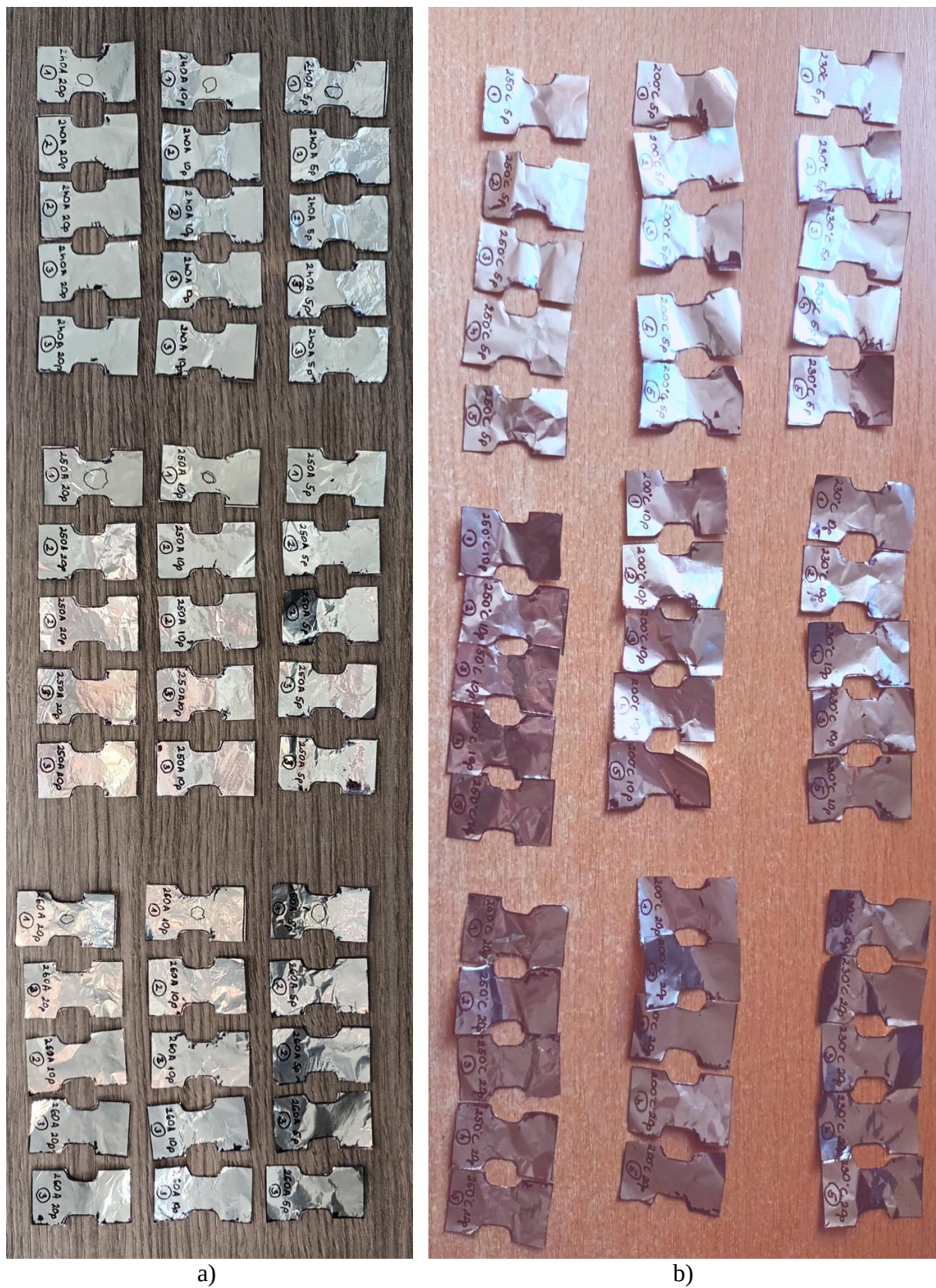
25. ábra a) Átfolyó árral kezelt fóliák szakító próbatestei; b) Kemencében kezelt fóliák szakító próbatestei (saját felvétel)
