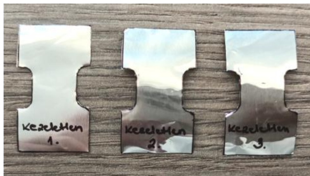
23. ábra Kiinduló állapotú szakító próbatestek (saját felvétel)
