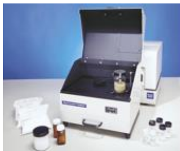
11. ábra: A Vis-NIR tartományú mérésekhez használt diszperziós (DS) Foss NIRSystems 6500 készülék a Rapid Content Analyzer (RCA) mintakezelő feltétellel
