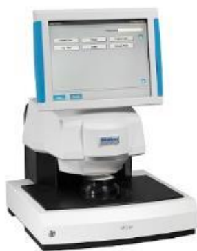
12. ábra: A NIR tartományú mérésekhez használt diódasoros (DA) Perten DA 7250 NIR Analyzer készülék
