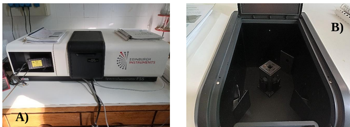
17. ábra: A) Az Edinburgh Instruments Spectrofluorometer FS5 B) a fluoriméter mintatere
