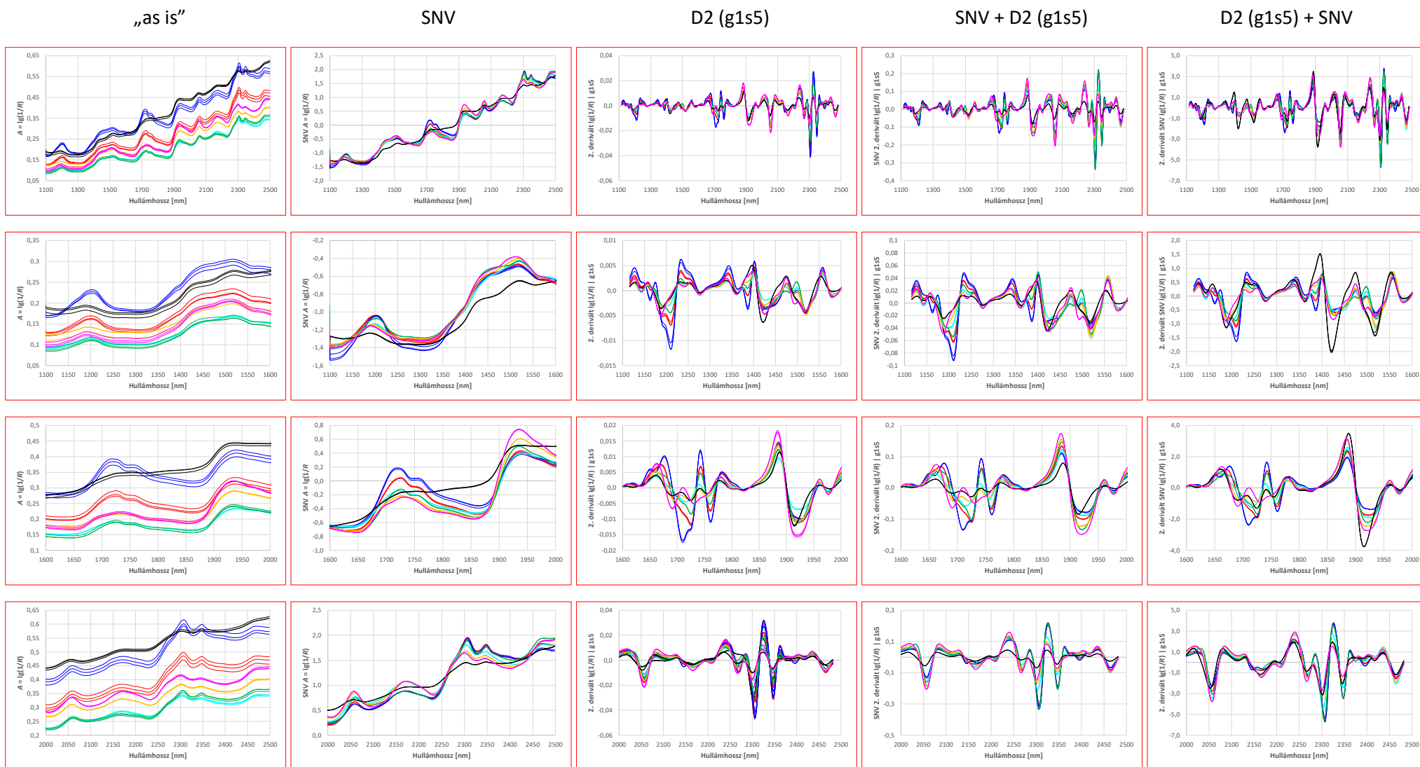
23. ábra: Recepollene PbS detektorral mért NIR spektrumai matematikai kezeléseik nélkül (1. oszlop), matematikai kezeléseikkel (2-3. oszlop) és ez utóbbiak kombinációival (4-5. oszlop) (hideg víz, forró víz, hideg víz + hideg IPA, forró víz + forró IPA, hideg NaLaSH + hideg IPA, Soxhlet + Cellosolve, H 3 PO 4 )
