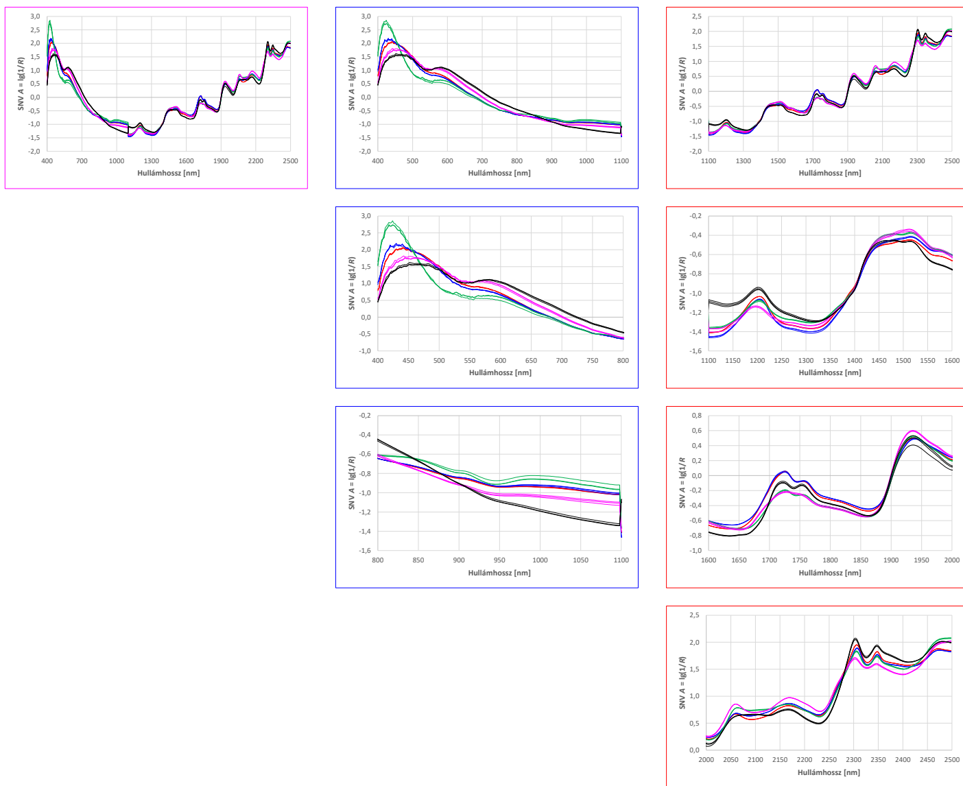
17. ábra: Napraforgópollenek Si és PbS detektorokkal mért, SNV matematikai kezelésen átesett Vis-NIR spektrumai (hideg víz, forró víz, hideg NaLaSH + hideg IPA, Soxhlet + Cellosolve, H 3 PO 4 )
