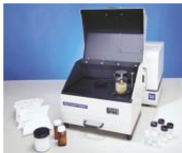
11. ábra: A diszperziós (DS), Vis-NIR tartományú mérésekhez használt NIRSystems 6500 készülék Rapid Content Analyzer (RCA) mintakezelő feltétellel (katalógusfotó: www.foss.dk )
