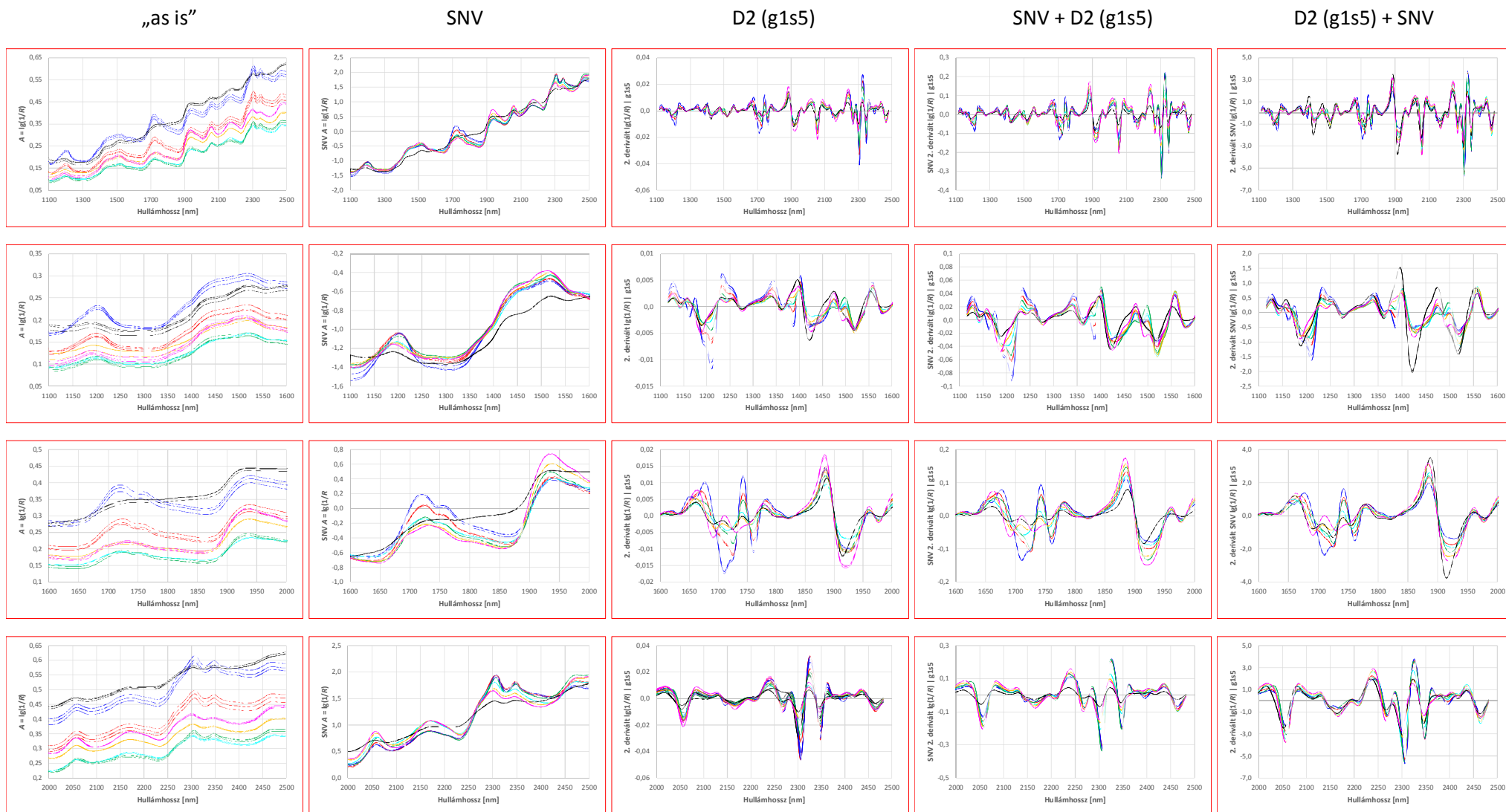
23. ábra: Receptolténes PbS detektorral mért NIR spektrumai matematikai kezeléseik nélkül (1. oszlop), matematikai kezeléseikkel (2-3. oszlop) és ez utóbbiak kombinációival (4-5. oszlop) (hideg víz, forró víz, hideg víz + hideg IPA, forró víz + forró IPA, hideg NaLaSH + hideg IPA, Soxhlet + Cellosolve, H 3 PO 4 )
