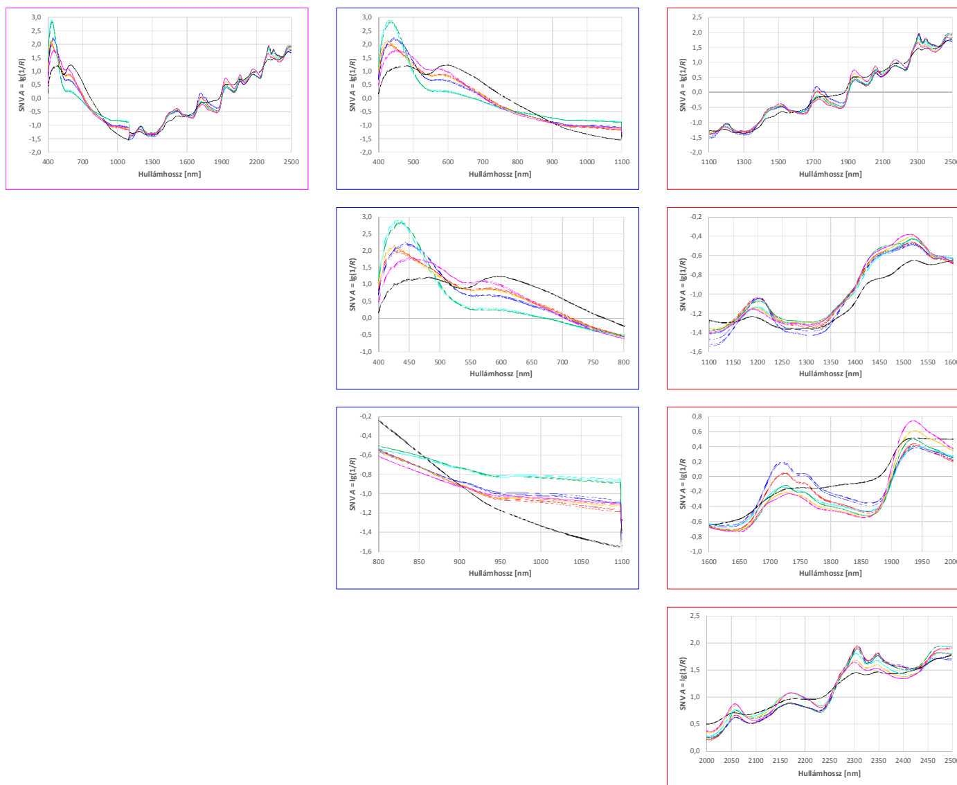
22. ábra: Repcepollene , Si és PbS detektorokkal mért, SNV matematikai kezelésen átesett Vis-NIR spektrumai (hideg víz, forró víz, hideg víz + hideg IPA, forró víz + forró IPA, hideg NaLaSH + hideg IPA, Soxhlet + Cellosolve, H_3PO_4 )
