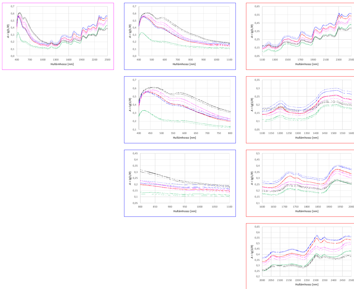
16. ábra: Napraforgópollenek Si és PbS detektorokkal mért, matematikai kezelés nélküi (ún. „as is”) Vis-NIR spektrumai (hideg víz, forró víz, hideg NaLaSH + hideg IPA, Soxhlet + Cellosolve, H 3 PO 4 )
