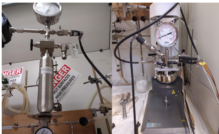
13. ábra Gázbüretta (balra), összeszerelt autokláv az 1,4-PDO szintéziséhez (jobbra)
