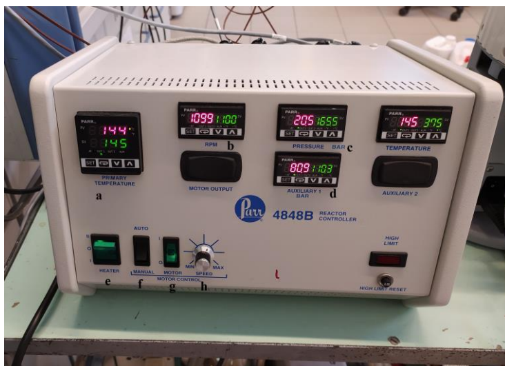
14. ábra 4848B szabályozó egy reakció szabályozása közben; Részei: a, reaktor hőmérséklet; b, fordulatszám; c, reaktor nyomás; d, gázbüretta nyomás; e, fűtés kapcsolója; f, keverő beállítása (kézi/automata); g, motor főkapcsolója; h, keverő kézi szabályozója
