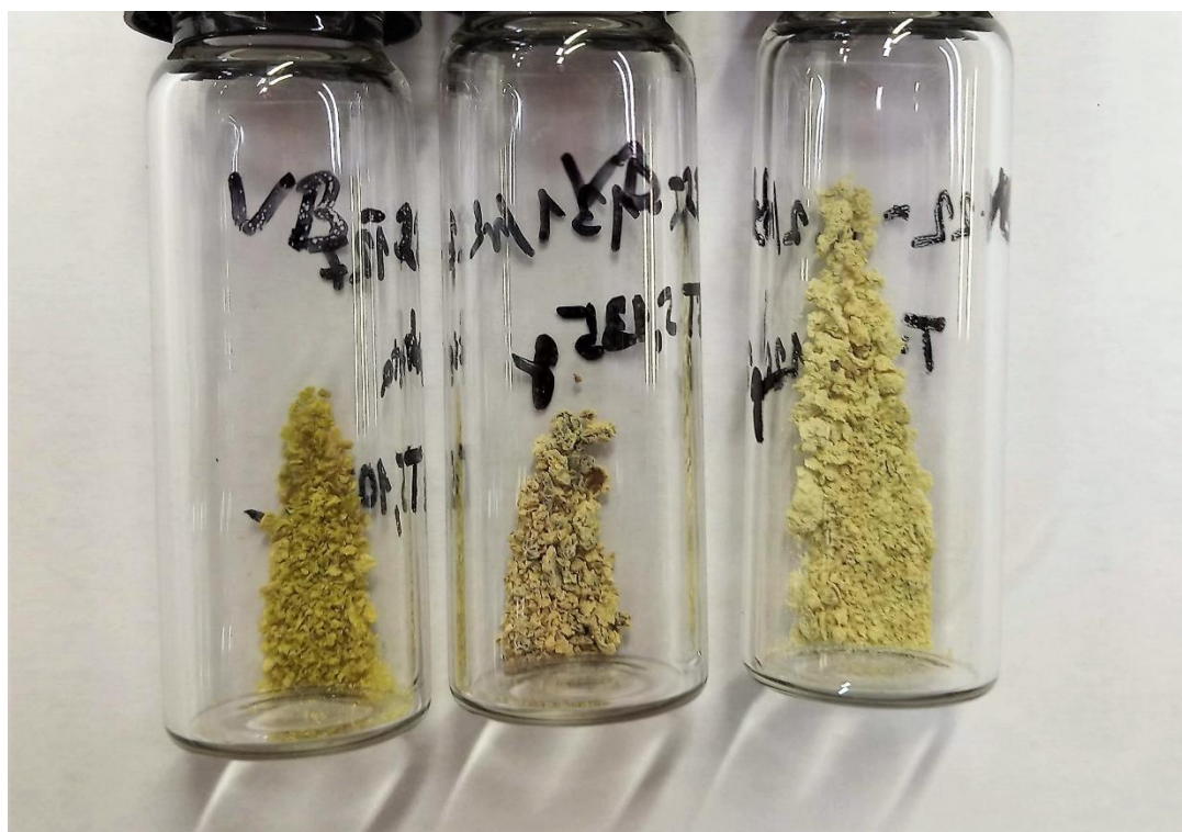
23. ábra. A 78 katalizátor felhasználás előtt (balra), Darzens -reakció után (középen), és MIRC-reakció után (jobbra)
