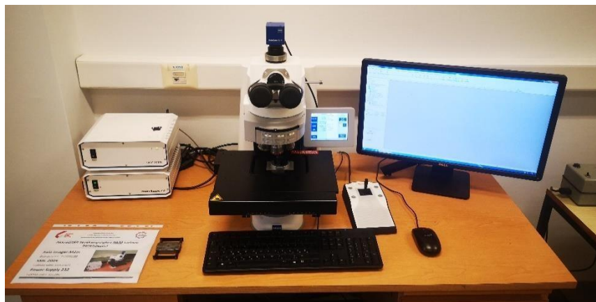
15. ábra: Zeiss Axio Imager M.2M fénymikroszkóp
