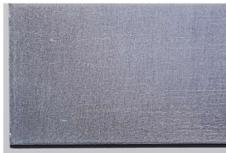
65. ábra: „D” módszerrel kezelt felület makroszkópos felvétele
