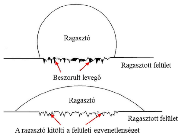
8. ábra: Szemléltető ábra a ragasztásnak kedvezőtlen (felső) és a kedvező (alsó) nedvesítésről [1]
