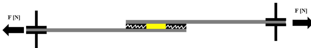
14. ábra: Nyírószilárdsági vizsgálatot szemléltető ábra
