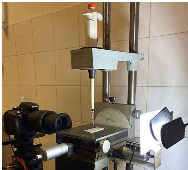
11. ábra: Alkalmazott nyugócsepp módszeres peremszög mérési rendszer szemléltetése
