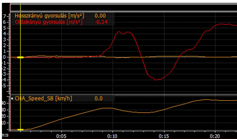
16. ábra: Jármű oldal- és hosszirányú gyorsulás-idő függvénye (Felső diagram: X tengely: Oldalgyorsulás [ m/s^2 ]; Y tengely: Idő [ s ]; Alsó diagram: X tengely: Járműsebesség [ km/h ]; Y tengely: Idő [ s ])
