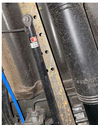
10. ábra: MoTeC 5715 lineáris potenciométer a járműbe szerelt állapotában (Saját kép)
