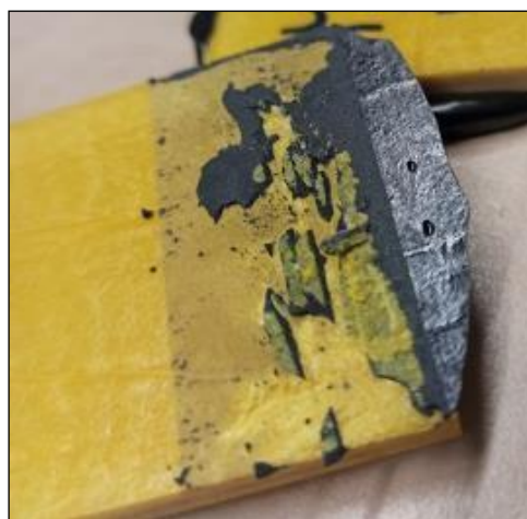
20. Ábra: Kohéziós és adhéziós hibajelenségek a homokszórt profilon Sikapower ragasztóval.
