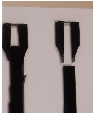
18. ábra Rendellenesen tönkrement próbatest a leszakadt fejjel
