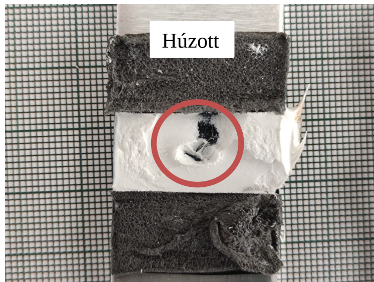
36. ábra: AB típusra jellemző tönkremenetel
