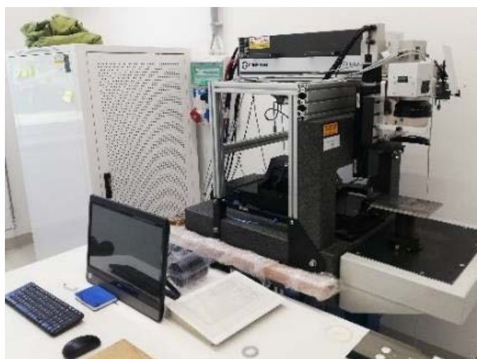
19. ábra: Coherent Monaco 1035-80-60 impulzus lézer
