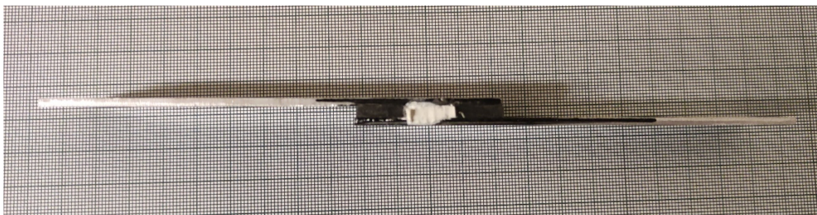
20. ábra: A nyírószilárdság méréséhez kialakított kötéselrendezés
