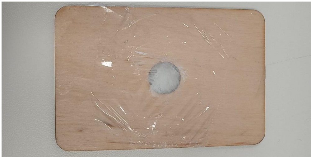
10. ábra Fa mintatartó a rajtalévő ragasztott polietilén fóliával
