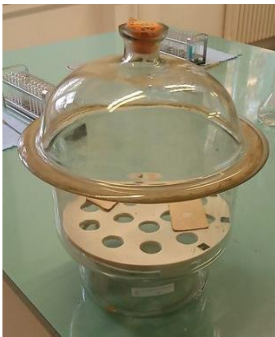
11. ábra Vízrel töltött exsikkátor és a ragasztó minták
