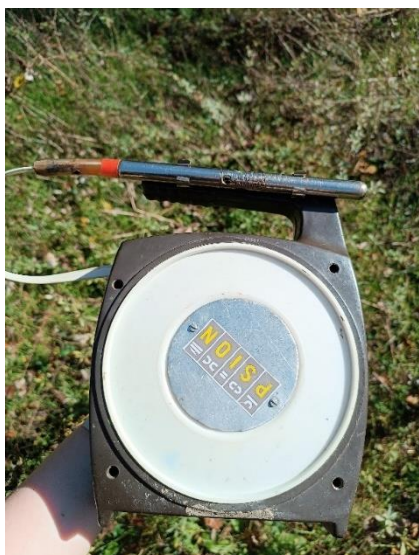
3. fénykép: Pision vízszintmérő, melyet a terepi méréseim során alkalmaztam forrás: saját, 2022.11.03.
