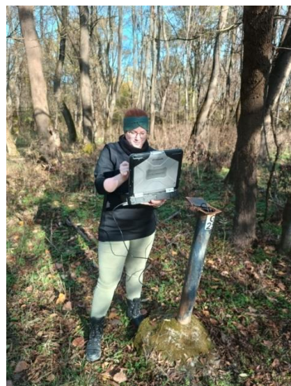
2. fénykép: Dataqua adatainak kiolvasása és mentése a G25-ös számú kútnál forrás: saját, 2022.11.03.
