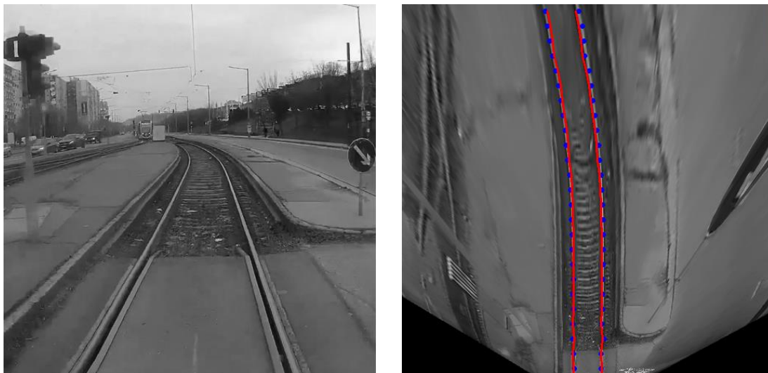
20. ábra. Felülnézeti pályadetektálás, balról jobbra, eredeti kép és detektált pálya
