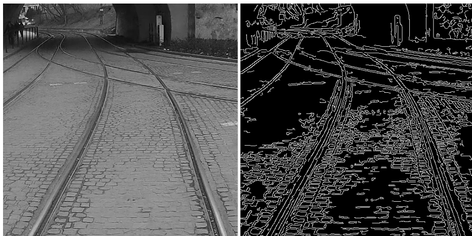
1. ábra. Bazaltkőkockás pályán alkalmazott Canny operátor előtte és utána
