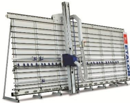
1.2. ábra - függőleges lapszabás gép (forrás [3])
