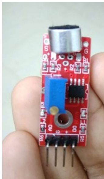
3.3. ábra. Keyes KY-038 mikrofon modul
