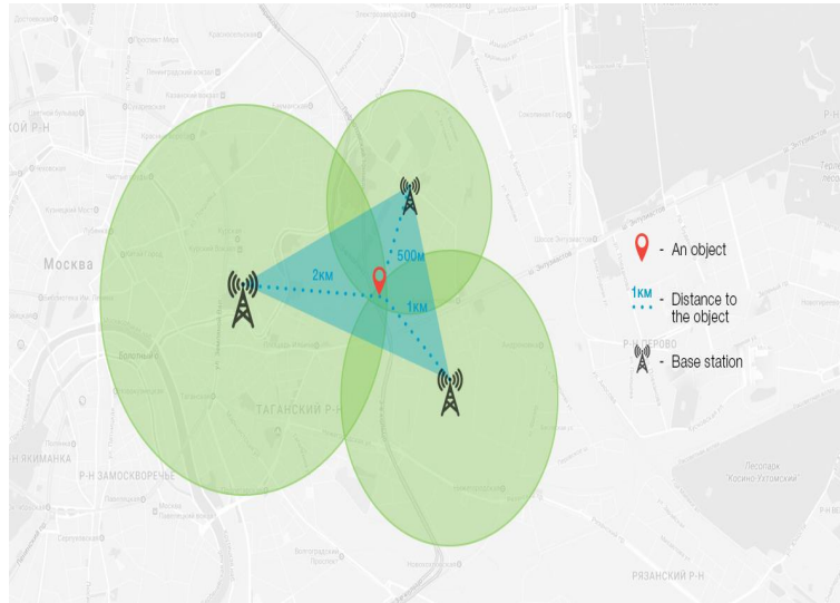
2. ábra Mobil háromszögelési séma [17]
