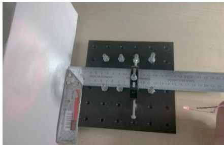
50. ábra - a házi fókusztávolság mérő tákolmányom
