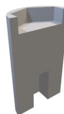
31. ábra - a motor - tengely kapcsolatot végző elem keresztmetszeti modellje. (készült az Autodesk Tinkercad webapp segítségével)
