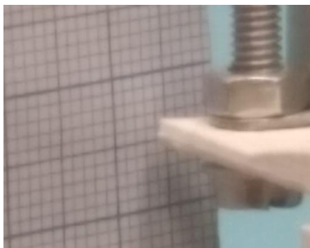
60. ábra - fókuszkereső rendszer beállítása - 50000 lépés körülbelül 1 mm – léptetés előtt
