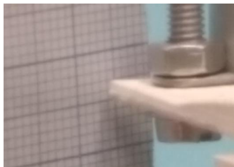
61. ábra - fókuszkereső rendszer beállítása - 50000 lépés körülbelül 1 mm – léptetés után
