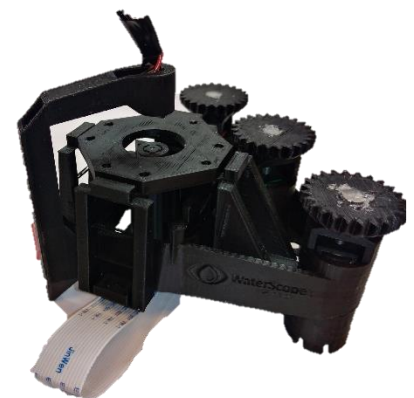
19. ábra - OpenFlexure mikroszkópállvány tesztelés után, beépített kamerával- saját kép
