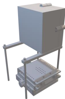
42. ábra - Egyben az optikatartó, az állvány és annak meghajtása, a korábban már bemutatott és felhasznált design objektumokkal.
