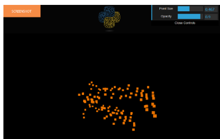
60. ábra - pyntcloud használatával vizualizálva egy fél alátét B-szkenje, saját kép
