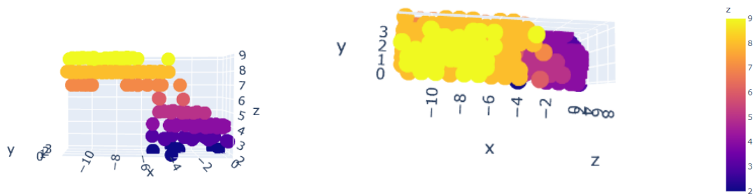
78. ábra - 10ft-os érme B szkeneje, ahol a magas értékeket a stage adja, a mélyeket az érme. A mérés lépésköze: 2mm
