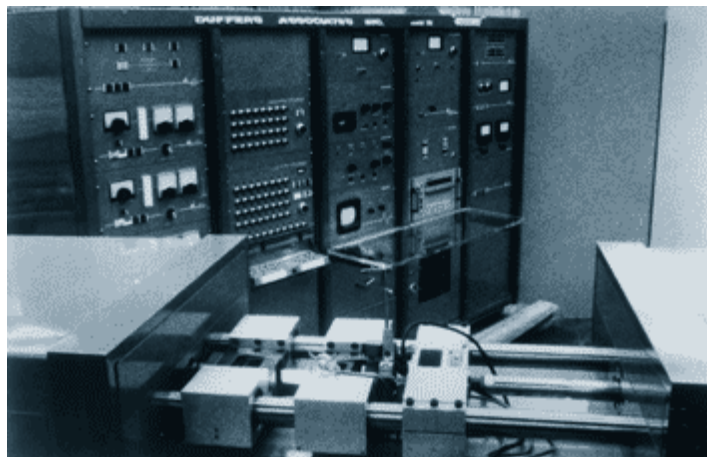
6. ábra. Gleeble 512 – es szimulációs berendezés, a Gleeble 2000 megjelenéséig fizikailag a legnagyobb konstrukció [8]
