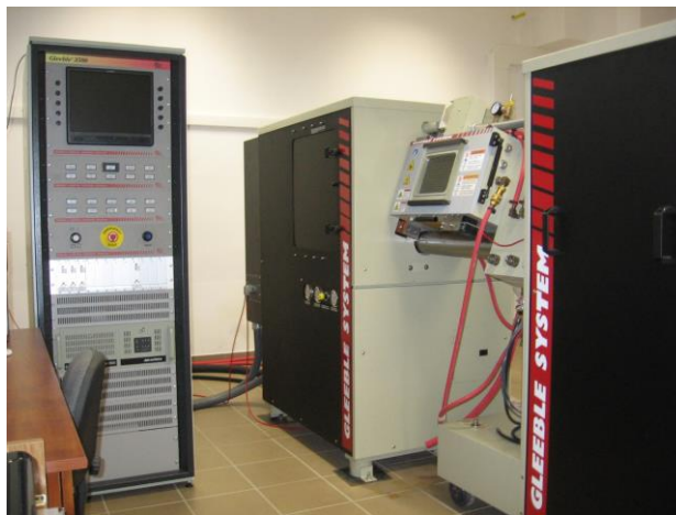
14. ábra. Miskolci Egyetem, Anyagszerkezzetani és Anyagtechnológiai Intézetének Gleeble 3500 - as fizikai szimulátora
