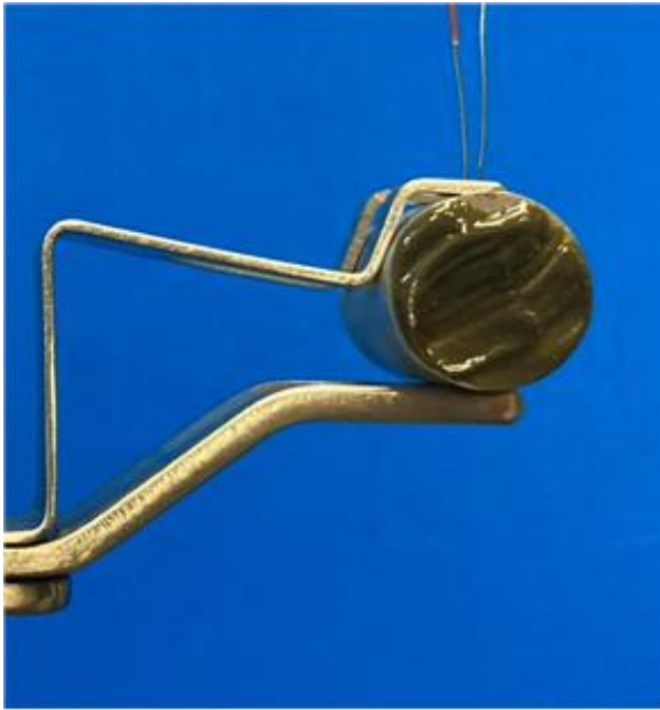
17. ábra. Érintkező felületek előkészítés: első – a próbatest vizsgálat utáni könnyebb leválasztását lehetővé tevő kenőanyag; második: grafitpapír elhelyezése
