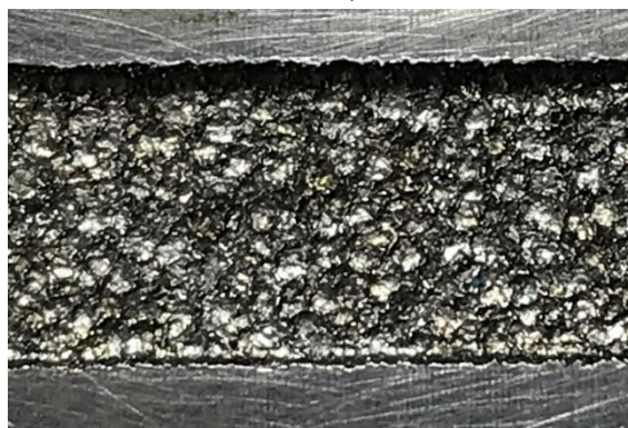
5. ábra A szikraforgácsolt felületminőség valós alakulása [12]
