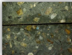
3.10. ábra: Próbatestek vízzáróság vizsgálat közben és kiértékelés alatt [saját fénykép]
