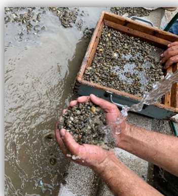
3.3. ábra: Felhasznált törtbeton adalékanyag, szitálása, átmosása [saját fényképek]
