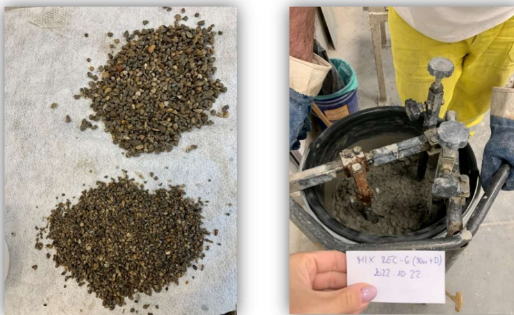
3.11. ábra: Újrahasznosított adalékanyag beáztatása; REC-6 (30m+D) beton keverése
