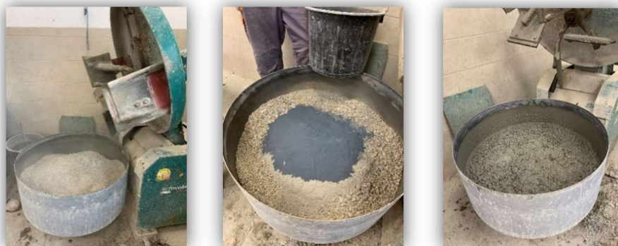
3.1. ábra: Hagyományos, szilikapor adagolású és újrahasznosított betonok keverés közben [saját fénykép]
