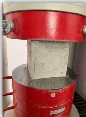
3.13. ábra: Tömegállandóságig szárítás. Próbatest nyomószilárdság vizsgálat közben [saját fénykép]
