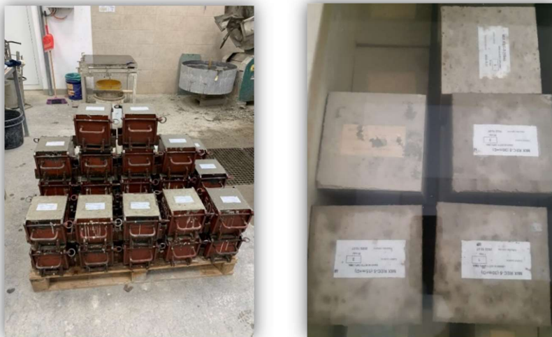
3.9. ábra: Elkészült próbatestek. Próbatestek vízben való tárolása [saját fénykép]
