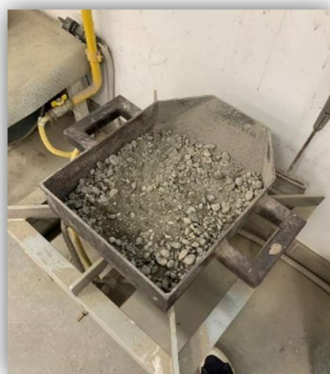
3.13. ábra: Tömegállandóságig szárítás. Próbatest nyomószilárdság vizsgálat közben [saját fénykép]
