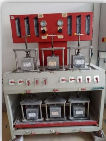
3.10. ábra: Próbatestek vízzáróság vizsgálat közben és kiértékelés alatt [saját fénykép]
