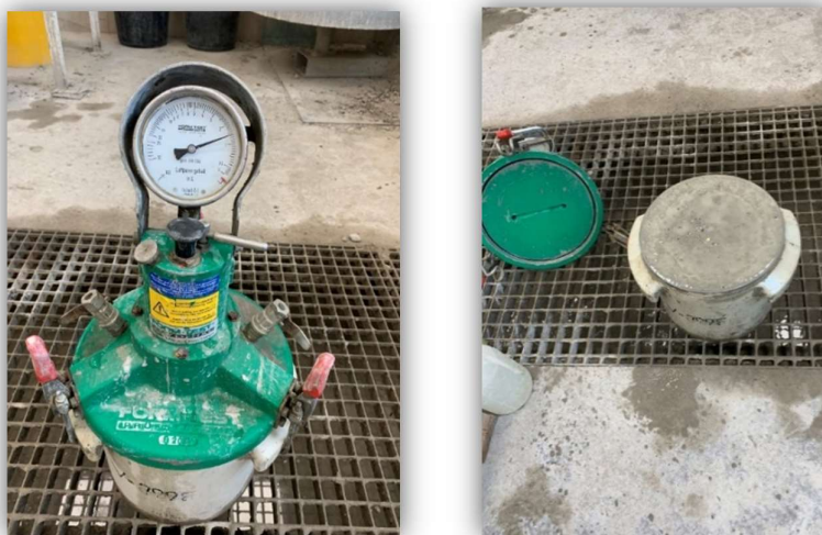
3.8. ábra: Frissbeton levegőtartalom mérése [saját fénykép]
