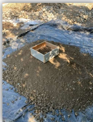
3.2. ábra: Felhasznált törtbeton adalékanyag, szitálása, átmosása [saját fényképek]
