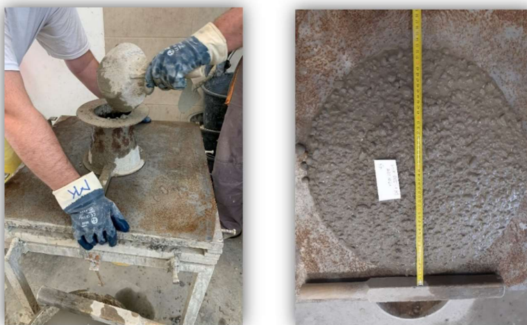
3.7. ábra: REC-6 (30m+D) típusú keverék terület mérése
