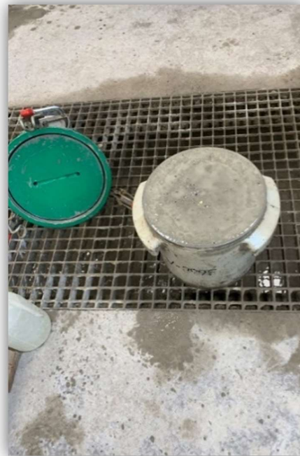
3.10. ábra: Frissbeton levegőtartalom mérése [saját fénykép]
