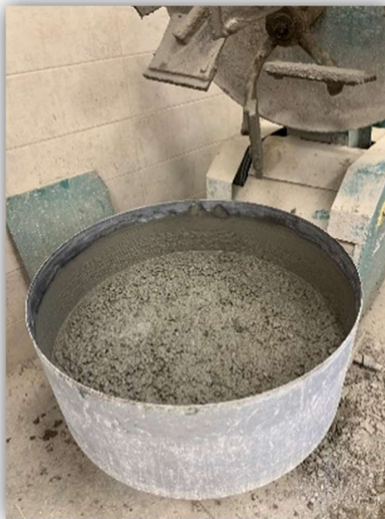
3.1. ábra: Hagyományos, szilikapor adagolású és újrahasznosított betonok keverés közben [saját fénykép]
