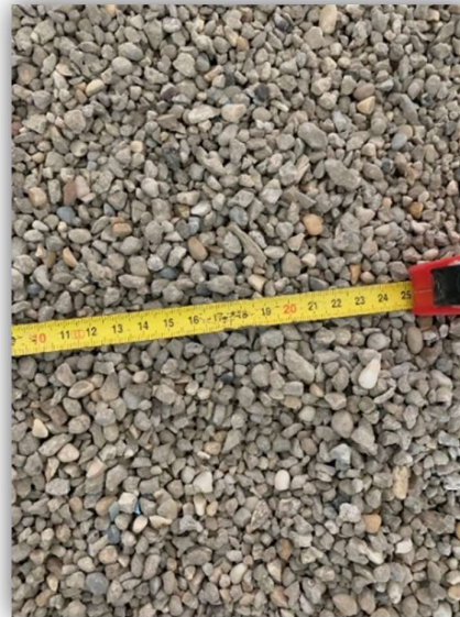
3.4. ábra: Átmosott adalékanyag [saját fénykép]
