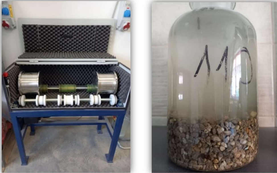
3.8. ábra: Mikro-Deval aprózódás és piknométeres vizsgálat [saját fénykép]
