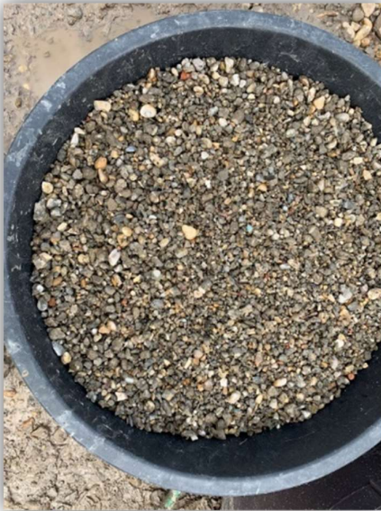
3.4. ábra: Átmosott adalékanyag [saját fénykép]
