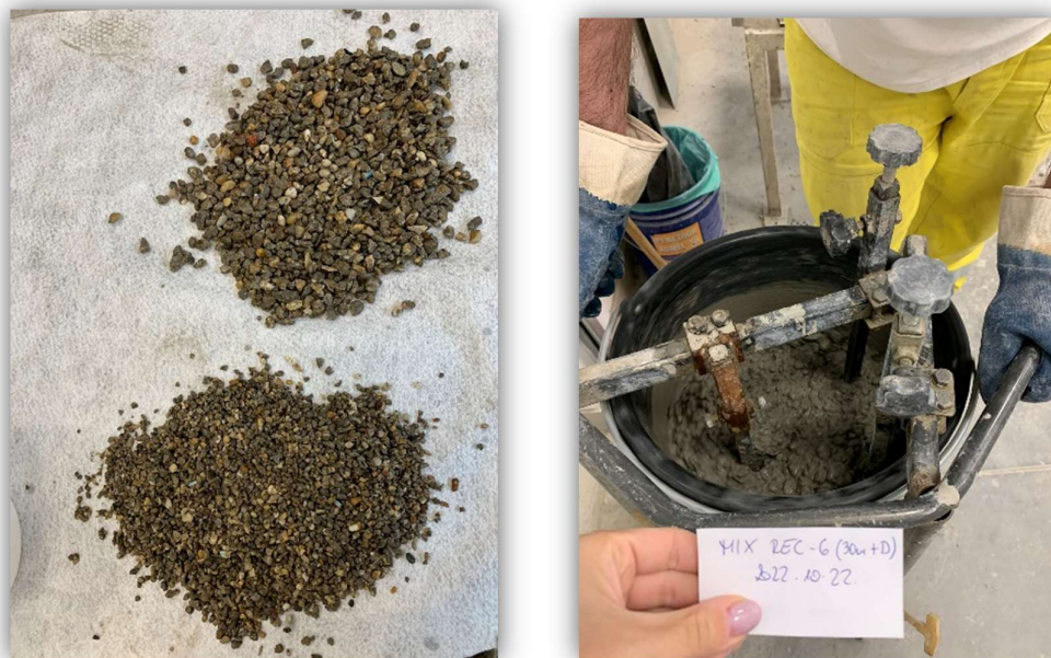
3.13. ábra: Újrahasznosított adalékanyag beáztatása; REC-6 (30m+D) beton keverése
