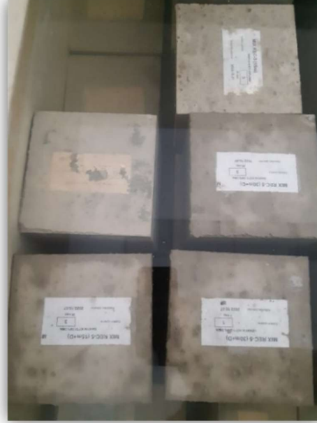
3.11. ábra: Elkészült próbatestek. Próbatestek vízben való tárolása [saját fénykép]
