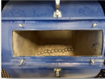
3.7. ábra: Los-Angeles aprózódás vizsgálat [saját fénykép]
