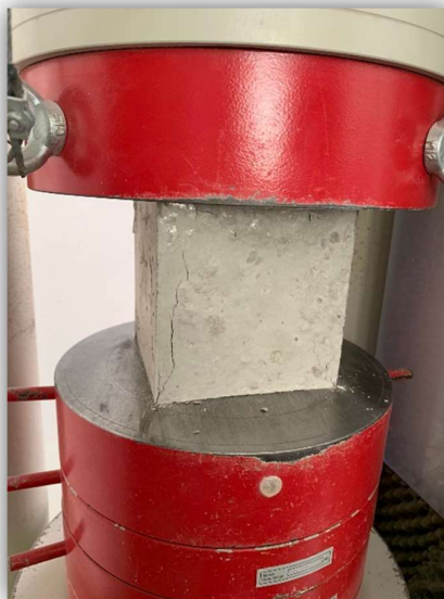
3.14. ábra: Tömegállandóságig szárítás. Próbatest nyomószilárdság vizsgálat közben [saját fénykép]
