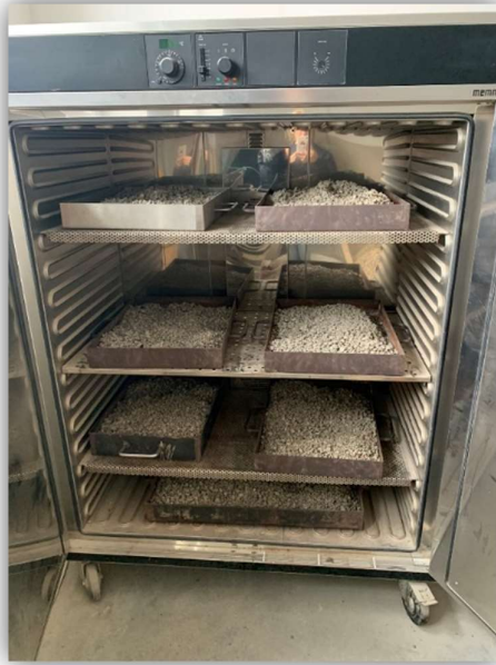
3.5. ábra: Szárítószekrény és gépi szita
