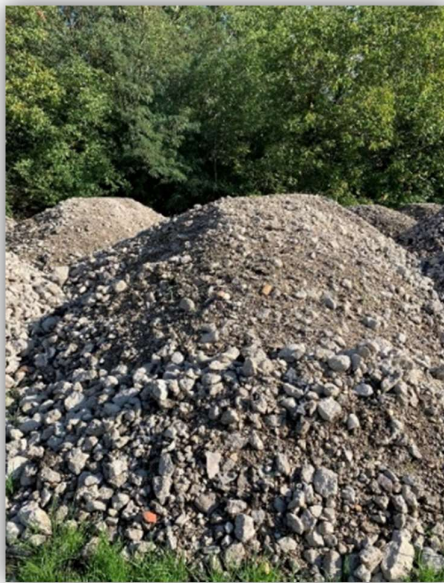
3.2. ábra: Felhasznált törtbeton adalékanyag, szitálása, átmosása [saját fényképek]
