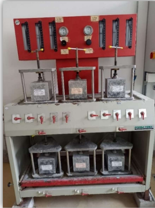
3.12. ábra: Próbatestek vízzáróság vizsgálat közben és kiértékelés alatt [saját fénykép]
