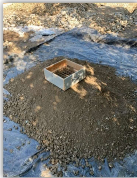
3.2. ábra: Felhasznált törtbeton adalékanyag, szitálása, átmosása [saját fényképek]
