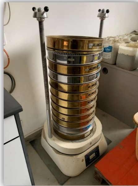
3.5. ábra: Szárítószekrény és gépi szita
