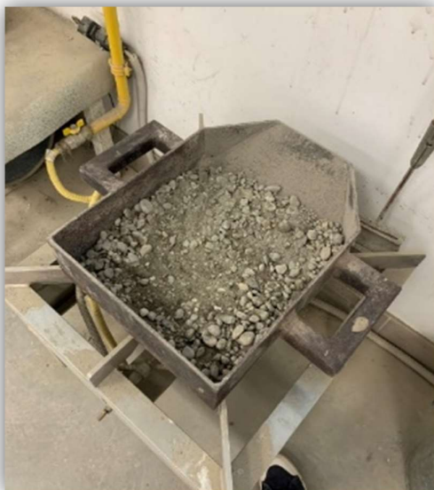
3.14. ábra: Tömegállandóságig szárítás. Próbatest nyomószilárdság vizsgálat közben [saját fénykép]
