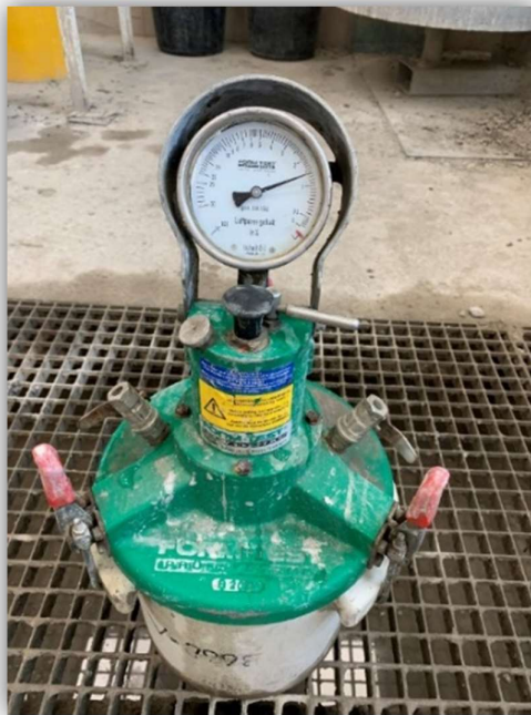
3.10. ábra: Frissbeton levegőtartalom mérése [saját fénykép]
