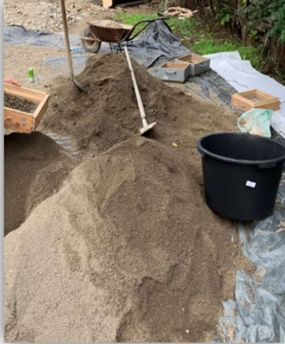
3.3. ábra: Felhasznált törtbeton adalékanyag, szitálása, átmosása [saját fényképek]
