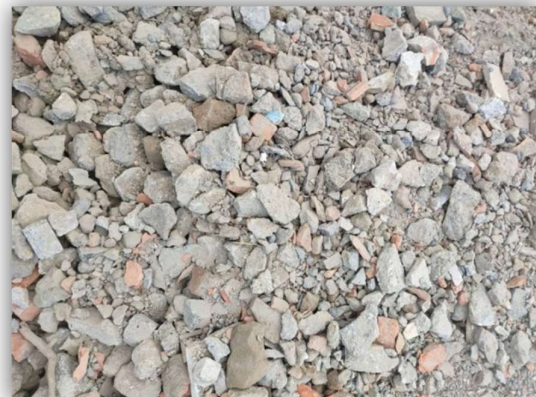
1.5. ábra: Medence bontása; Zúzott beton ágyazatként való felhasználása, Vasbeton medence - darált beton [saját fénykép]
