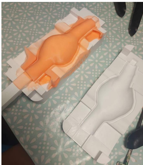
4-14. ábra Megdermedt szilikon a moldban
