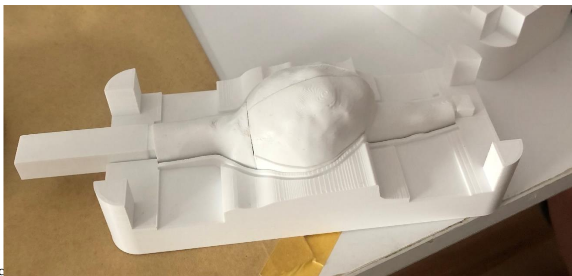
4-13. ábra A külső formába belehelyezett belső forma (mag)
