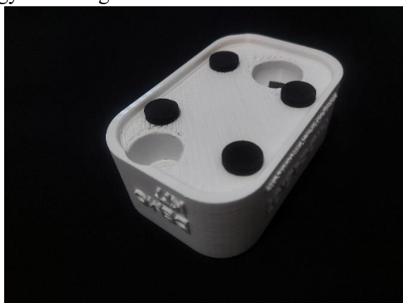
15. ábra A modell alja, a kiemelő lyukakkal és tapadó korongokkal
