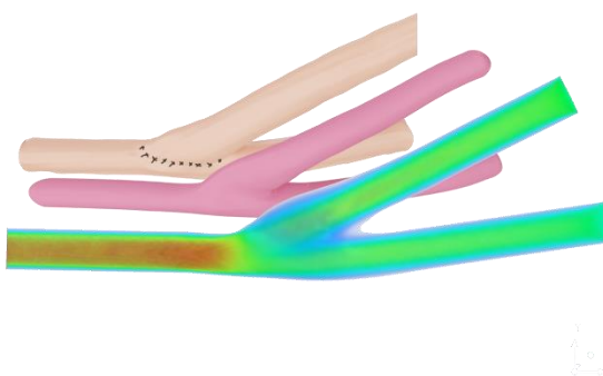
42. ábra Az ér külső- és belső geometriája (3D modell), illetve a hozzá tartozó áramlástanit kép
