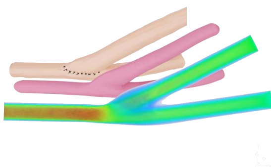
42. ábra Az ér külső- és belső geometriája (3D modell), illetve a hozzá tartozó áramlástanai kép
