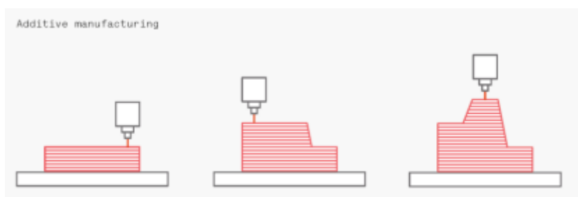
3. ábra 3D nyomtatás elvi rajza forrás: https://docplayer.hu/164169030-A-3d-nyomtat-as-alapjai.html
