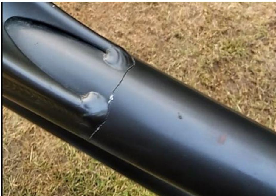
9. ábra: Vázon keletkező első repedés
