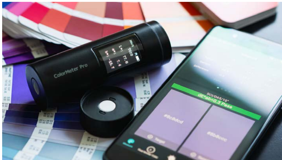
4.3. ábra. Nemrég beszerzett ColorMeter Pro színmérő (forrás: https://colormanagement.hu/shop/meromuszerek-szinmeres/spektrokolorimetek/colormeter-pro/ )
