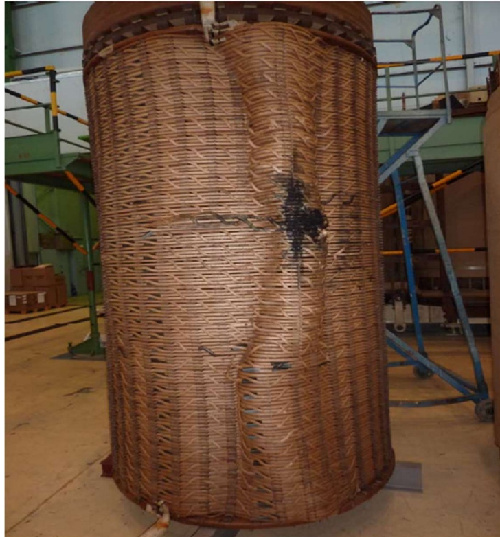
2.3.1-2. ábra Mágneses erőhatások következtében deformálódott tekercs [3]
