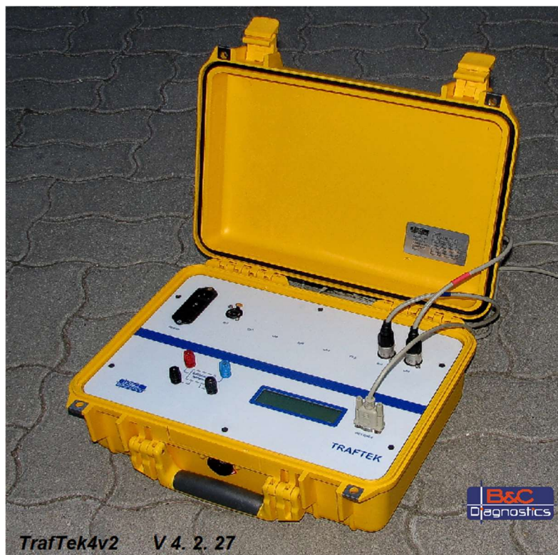
2.3.2-2. ábra Impedancia-frekvencia jelleggörbe felvételére alkalmazott B&C Diagnostics Traftek 4.2.27 műszer [7]
