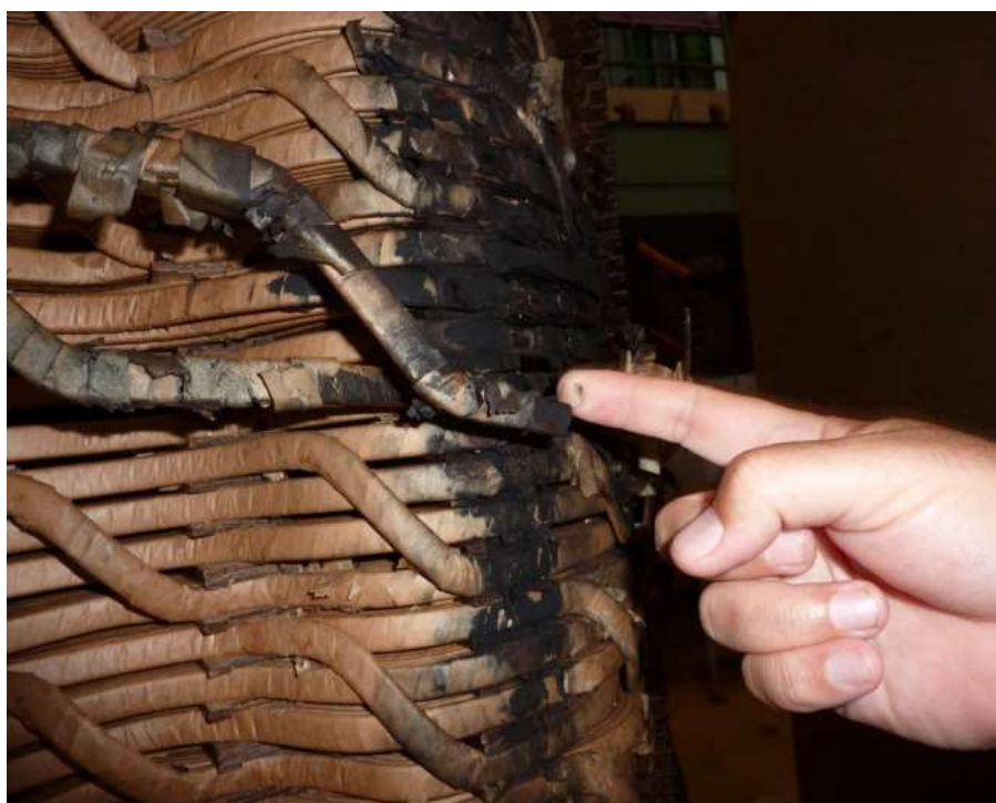
2.3.4-24. ábra DHBM 280000/400 típusú transzformátor 1W jelű fázistekercsének geometriai meghibásodása [3]
