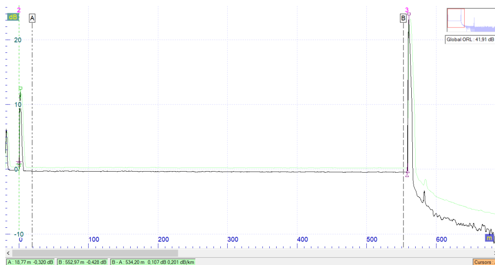
11. ábra: Hibamentesen telepített, földkábel OTDR grafikonja 1310 nm hullámhosszon
