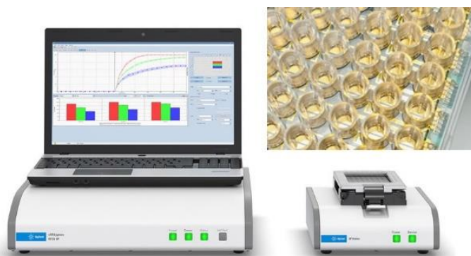
5. ábra. A műszer és a méréshez szükséges elektródákat tartalmazó 96-lyukú steril lemez.
