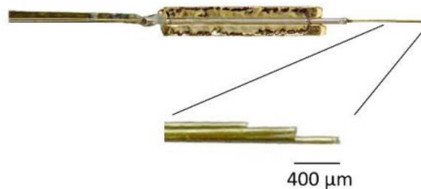
8. ábra. Tripoláris elektróda készítés egyik pillanatfelvétele (Absence epilepszia vizsgálata szabadon mozgó Long-Evans patkányokban. Kozák Gábor & Berényi Antal 2019)
