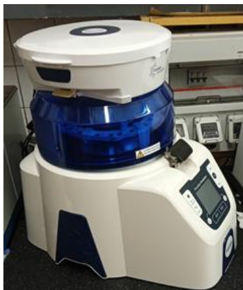
7. ábra: A Precellys® Evolution homogenizátor. Ezzel hajtottuk végre a TBI-t a muslicákon a Western blothoz.
