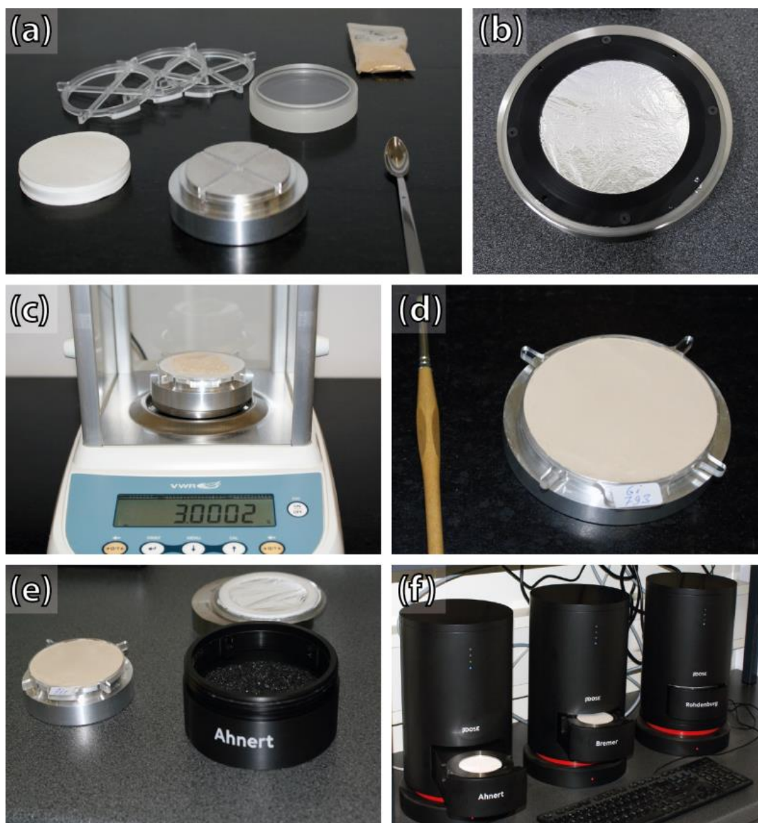
8. Ábra: A \mu Dose-eszközöket és berendezéseket bemutató fotók: (a) Mintatartó és berendezés a minta előkészítéséhez. b) Szcintillátor egység ezüst fóliával. c) 3,0 g mintaanyag lemérésére használt nagy pontosságú mérleg. (d) Előkészített minta mintatartón - átmérője 7cm. e) Előkészített mintaanyag és mérőedény. (f) \mu Dose-mérőeszközök (Kolb et al. 2021.)
