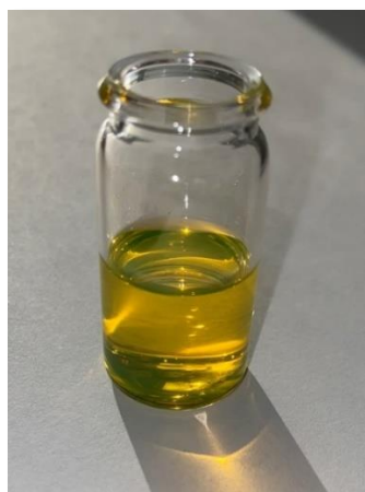
21. ábra: A 4h BODIPY monomer diklórmétán oldószerben készült oldata
