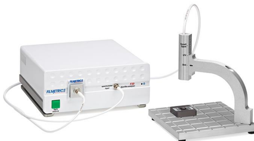
2.8. ábra: Filmetrics F20 készülék képe: a spektrométer és fényforrás, az osztott optikai szálköteg és a mérőállomás. (Forrás: [10])
