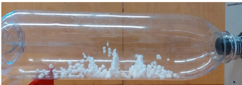
23. ábra: Rezonanciahelyzet 920 Hz-es frekvencia esetén. (saját kép)
