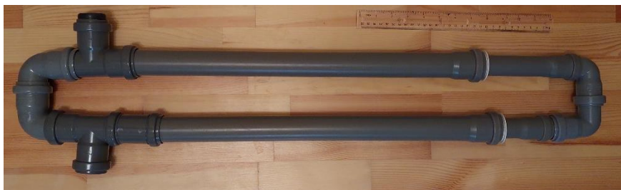
41. ábra: Interferenciacső 32 és 40 mm-es PVC elemekből. (saját kép)
