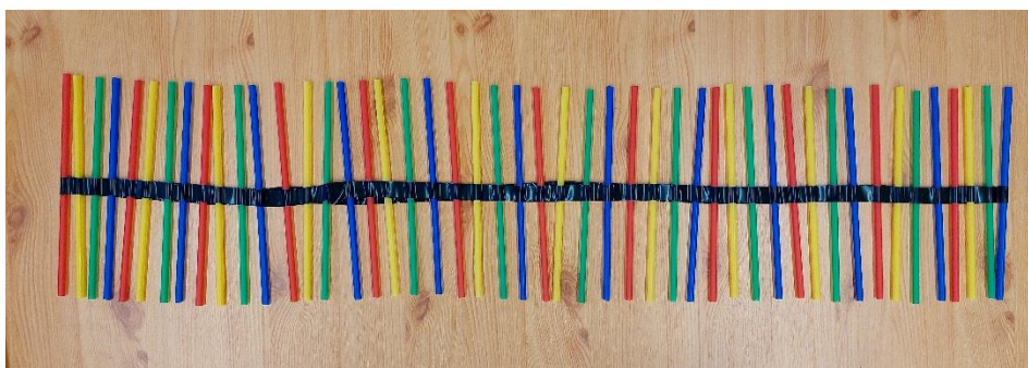
3. ábra: Szívószálból készült hullámgép. (saját kép)
