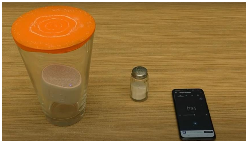
17. ábra: Üregbe helyezett hangszóróval megrezgetett hártya és telefon frekvencia generátor applikációval. (saját kép)
