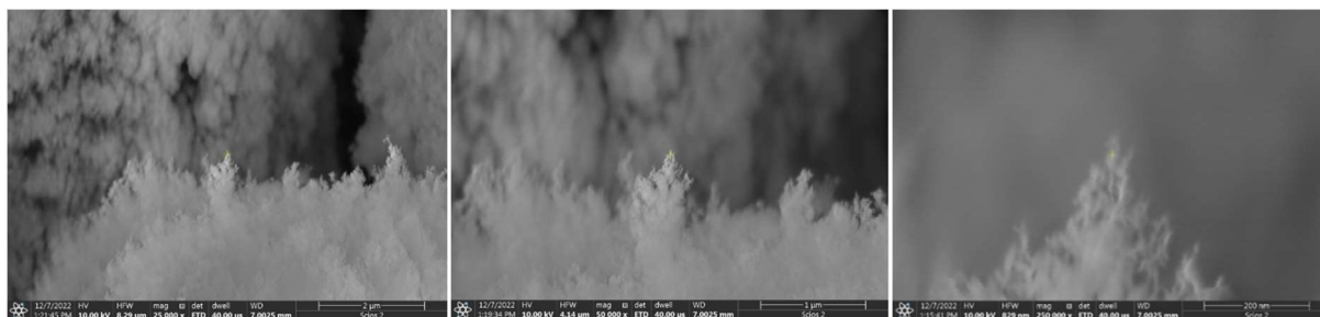
6. ábra A duralumíniumon kialakult felület nanoszerkezete.
