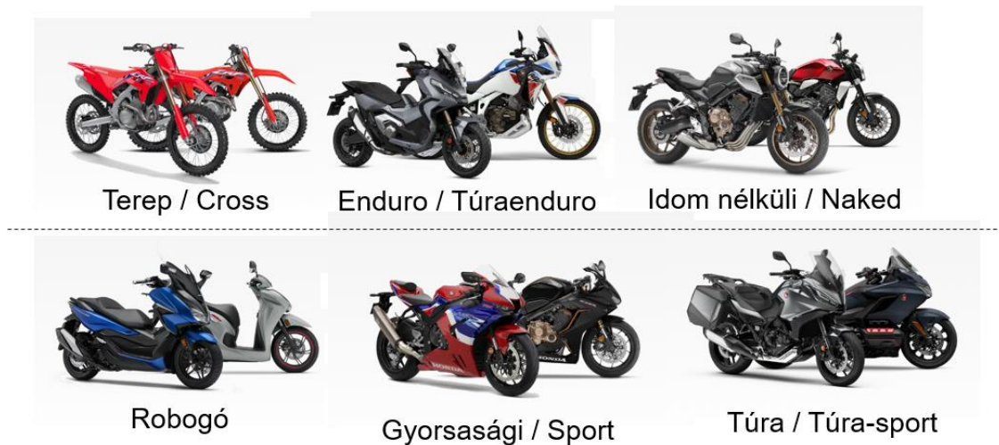
1. ábra: Motorkerékpárok kivitelei
