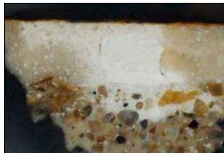
11.kép. Arriccio réteg folyami homok. XCLV. épület „páncélos alakot ábrázoló falfestmény” oldalfal, Gorsium (fotó: Harsányi– Kurovszky 2004).
