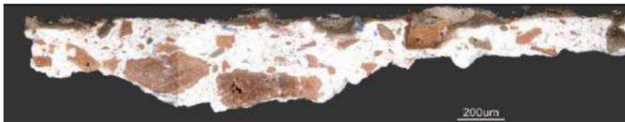
2.Kép. Téglatörmelékes minta keresztmetszet csiszolata. (fotó: La Magdalena, in Alcalá de Henares/Madrid OM, Guerra et al. 2014, fig.3.).
