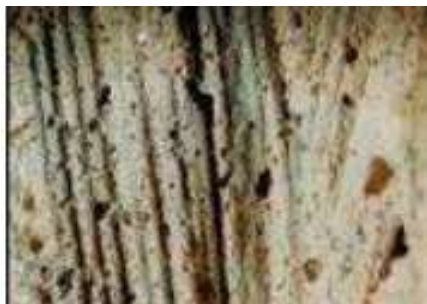
7.Kép. Növényi szálak– anyag lenyomata a vakolatban. Sztereo mikroszkópos felvétel. Gorsium, XL épület kis helyisége. (fotó: Galambos Éva).
