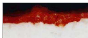
64.Kép. Keresztmetszet csiszolat, PLM (obj. 10x) ráeső fény (fotó: Galambos Éva).
