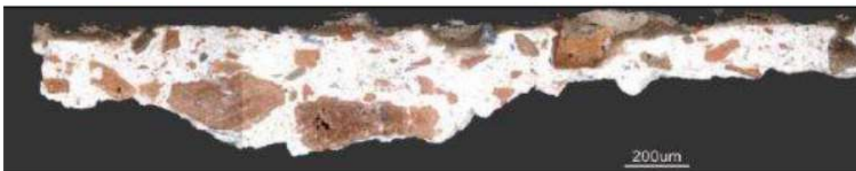
6.Kép. Téglatörmelékes minta keresztmetszet csiszolata. (fotó: La Magdalena, in Alcalá de Henares/Madrid OM, Guerra et al. 2014, fig.3.).
