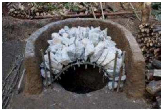
5.kép. Mészkörögek a gödör fölötti boltozaton. (fotó: Thér, R.– Maršálek, D.: Experimental Lime Burning Based on the Findings from the Roman Empire Period in: Experimental Archaeology Issue 2013/1.)
