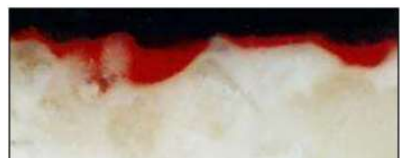
67.Kép. Keresztmetszet csiszolat, PLM (obj. 10x) ráeső fény. (fotó: Galambos Éva).
