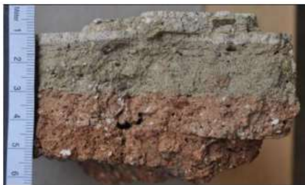
28.Kép. A két alsó réteg töltőanyaga cserép vagy téglaréteg. Szőny/ Dunapart, 1-es lelőhely. (fotó: Harsányi 2016, 47.).
