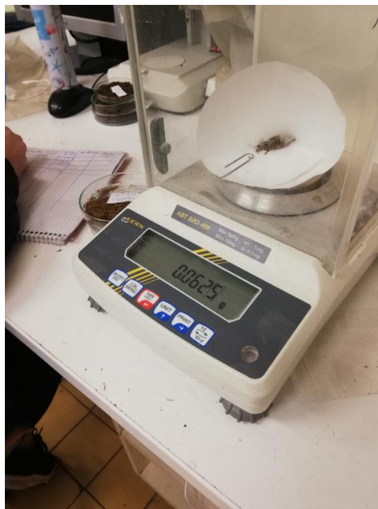
5-6.ábra: Minták kiszárítása szárítaszekrény segítségével, majd tömegmérés
