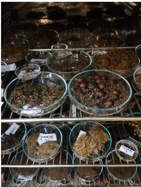
5-6.ábra: Minták kiszárítása szárítaszekrény segítségével, majd tömegmérés
