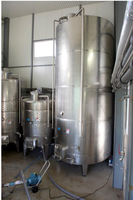
17. ábra: Saválló erjesztőtartály
