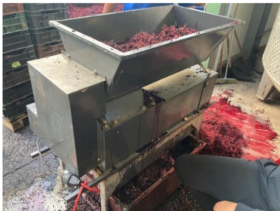
15. ábra: Bogyózó berendezés
