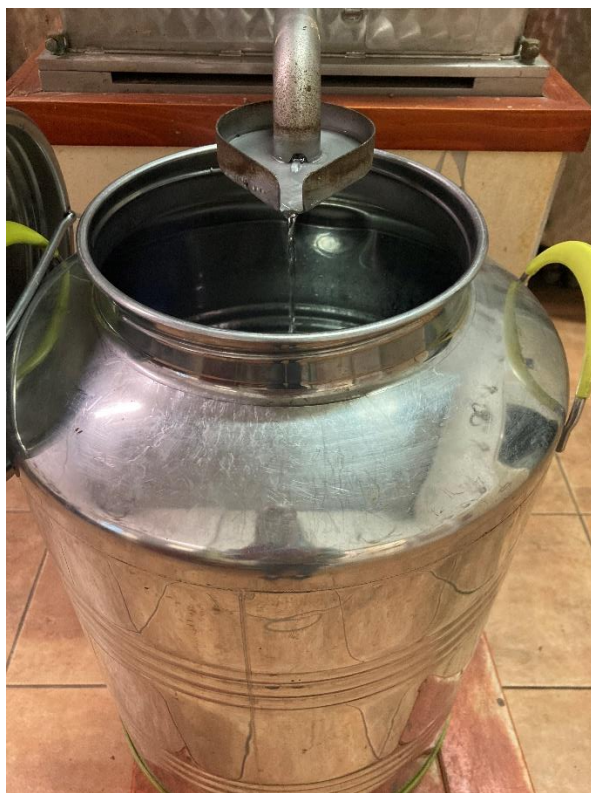
22. ábra: Tömény pálinka tárolására alkalmas saválló tárolóedény
