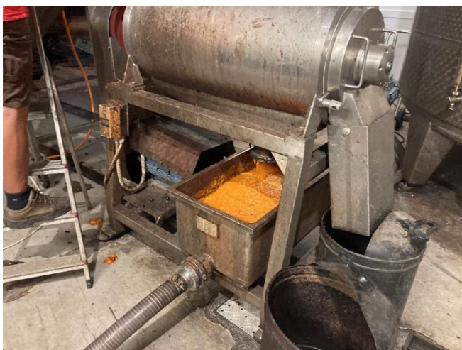
13. ábra: GM-MP5 típusú magozó-passzírozó
