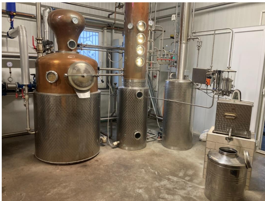
21. ábra: KOTHE K 1000N nagyteljesítményű pálinkafőző berendezés
