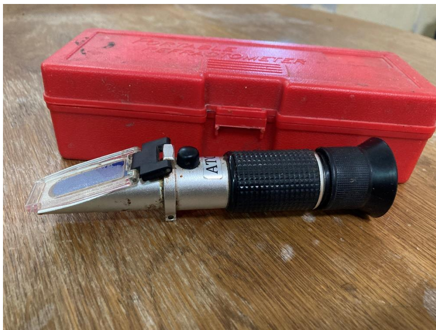
23. ábra: Kézi refraktométer
