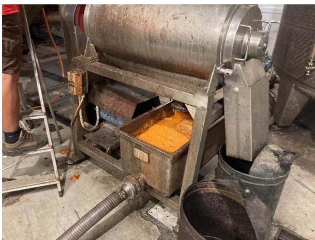
11. ábra: GM-MP5 típusú magozó-passzírozó
