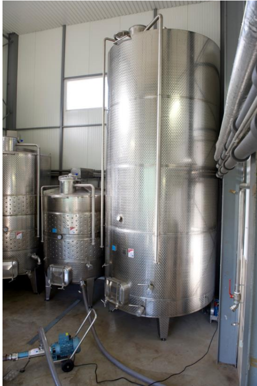
15. ábra: Saválló erjesztőtartály
